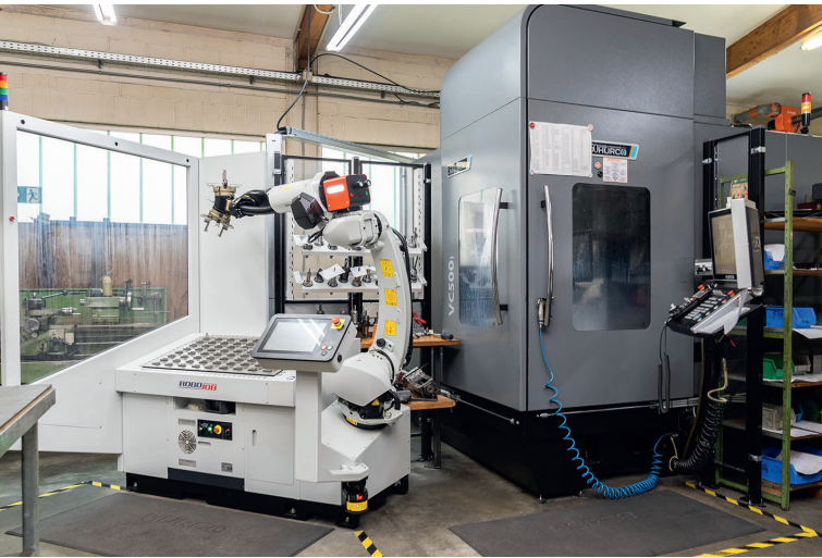
2 Befreit das Bedienpersonal von Einlegearbeiten und schafft Ressourcen für wichtigere Aufgaben: die kompakte 'Fertigungszelle' aus fünfachsigem VC 500 i und Mill-Assist auf einen Blick © Hurco
